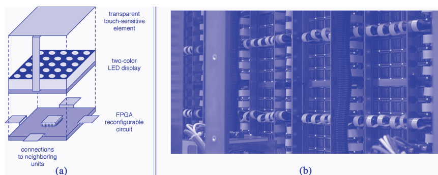
FIGURE 2 – (A) REPRÉSENTATION SCHÉMATIQUE D'UNE UNITÉ DU BioWall, (b) VUE PARTIELLE DES CIRCUITS FPGA XILINX
