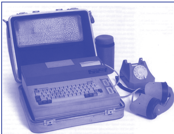
ORDINATEUR PORTABLE SCRIB (1977) AVEC COUPLEUR ACOUSTIQUE DÉVELOPPÉ PAR JEAN-DANIEL NICLOUD AU LAMI
